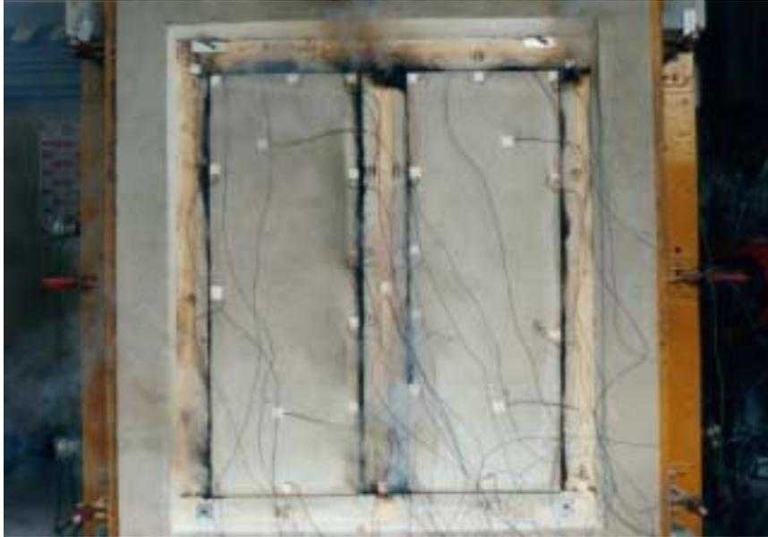
Bild 3 Prüfkörper des Versuches P nach 90 Minuten
