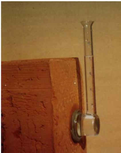
Bild 13 Untersuchung mit dem Karsten'schen Prüfröhrchen im Labor
