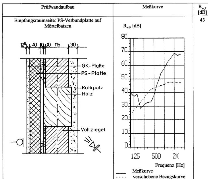
Bild 18 Aufbau und Messkurve von Variante 7
