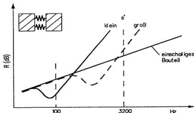
Bild 7 Einfluss der Steifigkeit  $s'$  des Dämmstoffes oder der Luft zwischen beiden Schalen eines zweischaligen Bauteils auf die Schalldämmung  $R$ <sup>4/</sup>
