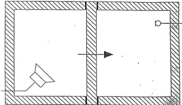
Bild 2 Prüfstand zur Bestimmung des Schalldämmmaßes R
