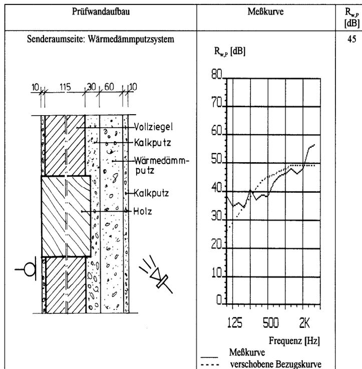
Bild 16 Aufbau und Messkurve von Variante 4
