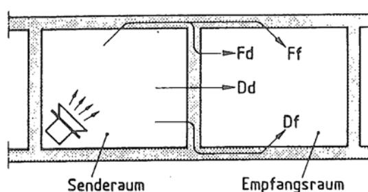
Bild 8 Wege der Schallübertragung nach DIN 52210
