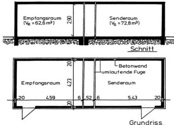
Bild 9 Grundriss und Schnitt des Prüfraums
