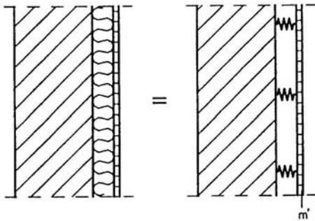
Bild 6 Masse-Feder-System einer zweischaligen Wand
