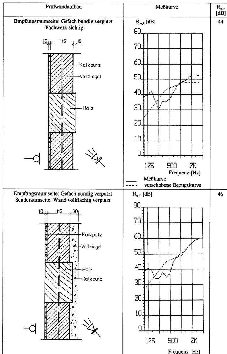
Bild 15 Aufbau und Messkurve von Variante 2 und 3
