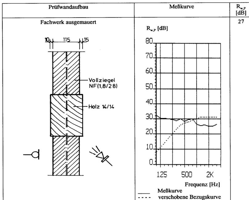
Bild 13 Aufbau und Messkurve von Variante 1
