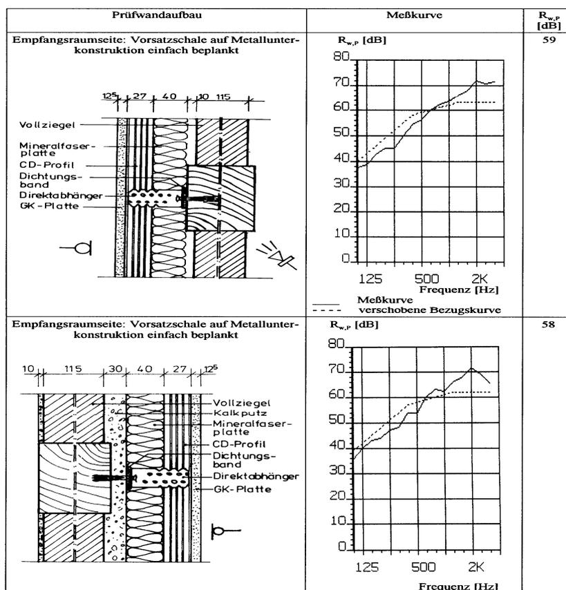
Bild 17 Aufbau und Messkurve von Variante 5 und 6
