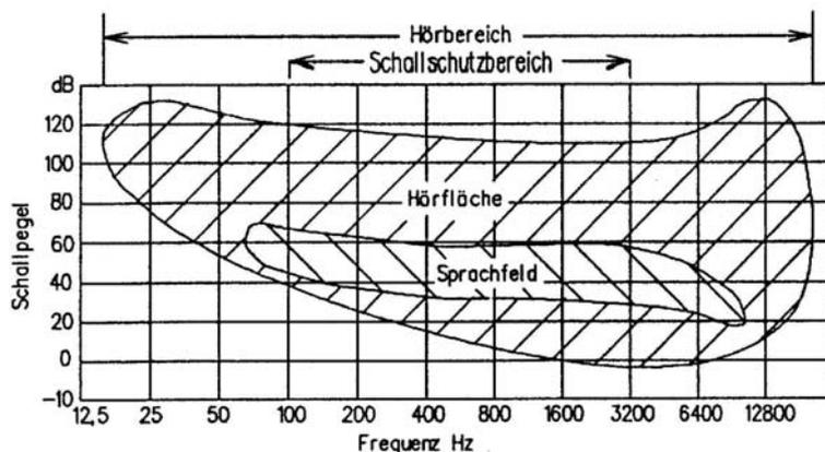
Bild 1 Hörbereich des menschlichen Ohres<sup>2/</sup>
