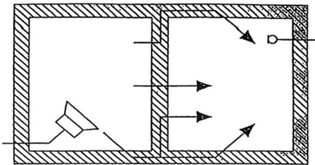
Bild 3 Prüfstand zur Bestimmung des Schalldämmmaßes R'
