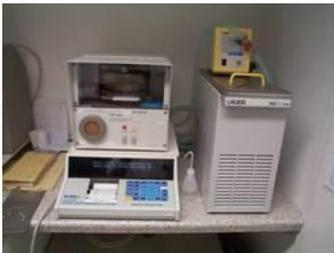
Die Diffusionsmessungen können normkonform gravimetrisch und/oder mit mikroprozessor gesteuerter Sensortechnik durchgeführt werden (Lyssy-Methode). Zu den genormten Verfahren gehören z. B. EN ISO 12572, EN 1931, EN ISO 12571 und die darin enthaltenen Klimate.
