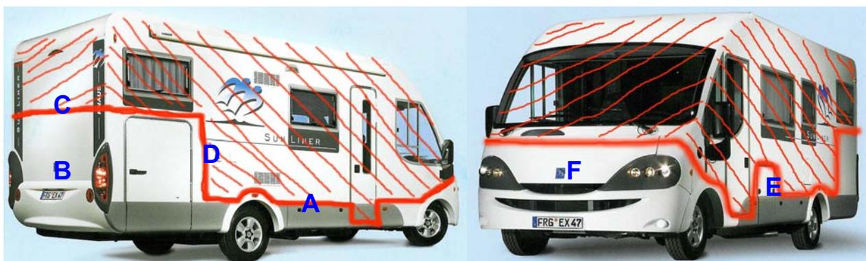
**Abbildung 3-1:** Kennzeichnung des gedämmten Innenbereichs (rot dargestellt).
