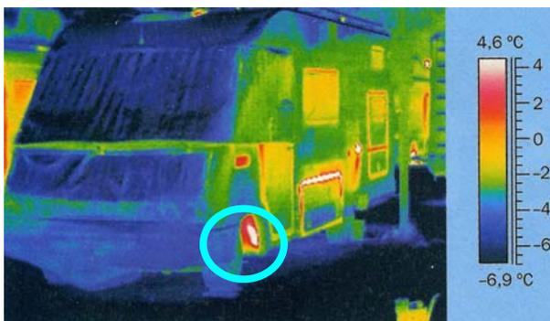
**Abbildung 4-2:** Die Problemzone Fahrerhaus wird im Bild wirkungsvoll durch eine auf Maß gefertigte Außenisiermatte entschärft. Im Vergleich zu Abbildung 4-1 erweist sich auch die Abdeckung des Motorraumes als dämmtechnischer Vorteil. Als Schwachstelle ist hier ein deutlicher Wärmeverluste im Bereich des vorderen Radhauses zu erkennen.
