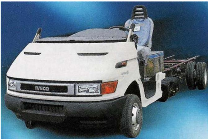
**Abbildung 2-10:** Windlauf eines integrierten Wohnmobils vor der Montage des Aufbaus. Häufig entfallen bei diesen Windläufen auch Außenkotflügel und Motorhaube.
