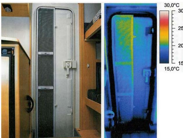
**Abbildung 4-8:** Aufgrund ihres thermisch nicht getrennten Rahmens und der fehlenden zweiten Dichtungsebene, stellt diese Tür im Bereich des Rahmens eine von ihrer Länge her nicht zu unterschätzende Wärmebrücke dar.
