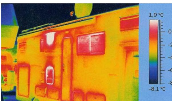
**Abbildung 4-5:** Welchen negativen Einfluss viele Außenwanddurchbrüche auf die ansonsten gute Dämmung dieses Wohnmobils haben, veranschaulicht dieses Thermogramm. Als konstruktiv gut gelöst können die thermisch gut voneinander getrennten Bauteilanschlüsse von Wand und Dach bewertet werden (Siehe zum Vergleich Abbildung 4-6).
